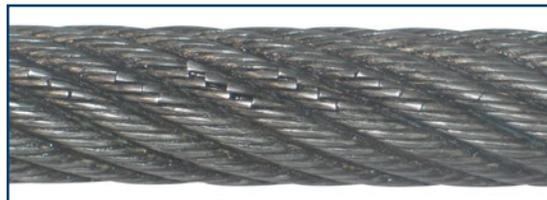
Rotura de alambres por desgaste localizado
