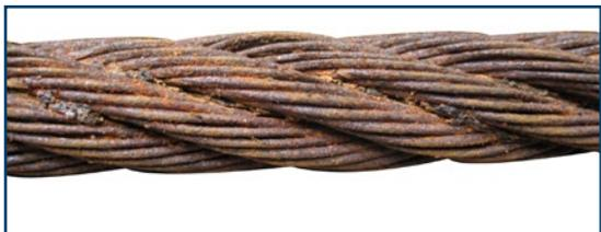
Daño producido por oxidación
