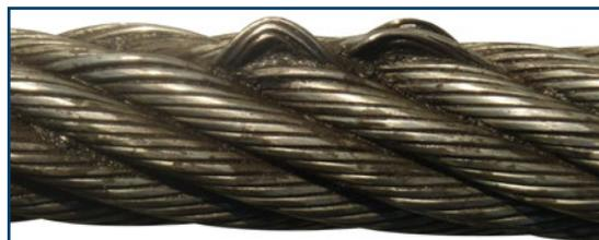
Daño por rotación del cable
