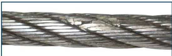
Desgaste localizado y Daño Externo
